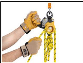
Das Lösen des Klemmnockens und das Führen des Seils um die in das Hauptseitenteil integrierte Bremse ermöglichen ein komfortables und präzises Ablassen der Last.
